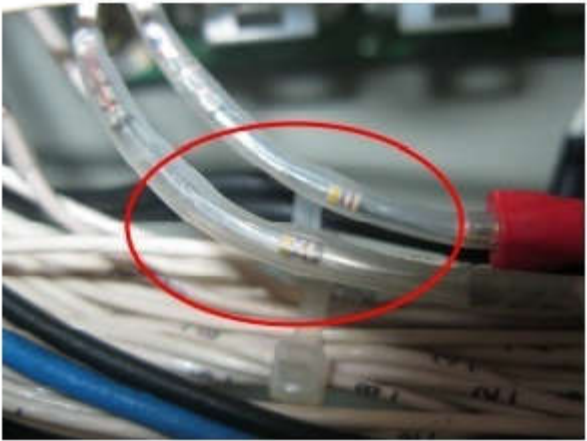
Resistencia de 470 Ohmios ¼ W ( referencia 290101450) Situadas en el interior del cuadro de mandos inferior en la parte superior derecha
